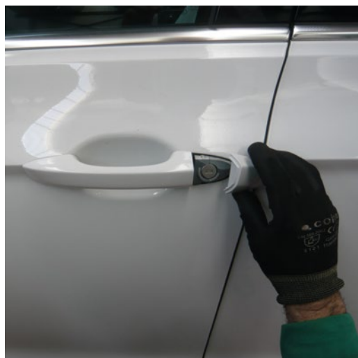
► Bombín de puerta, sin daños
