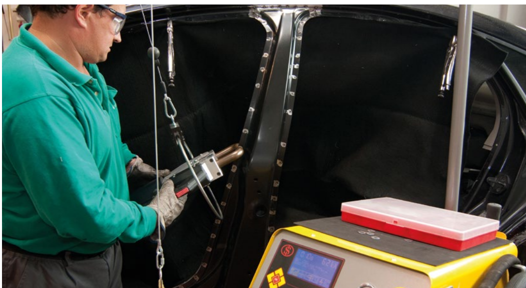
► Sustitución de elementos de aceros de distinta composición, mediante soldadura.
